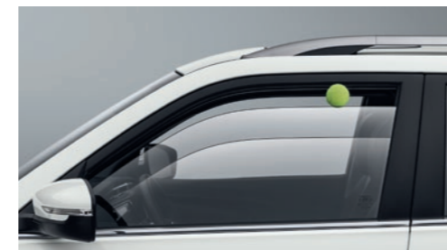
Стеклоподъемник двери водителя с функцией защиты от защемления
