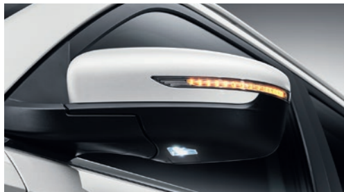
Светодиодные повторители указателей поворота и лампы подсветки околodверного пространства
