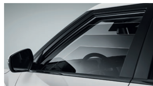
Электрический стеклоподъемник двери водителя с функцией защиты от защемления
