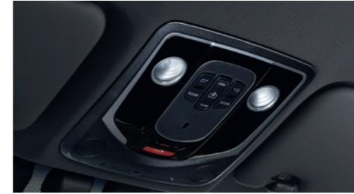
Потолочная консоль с плафонами освещения
